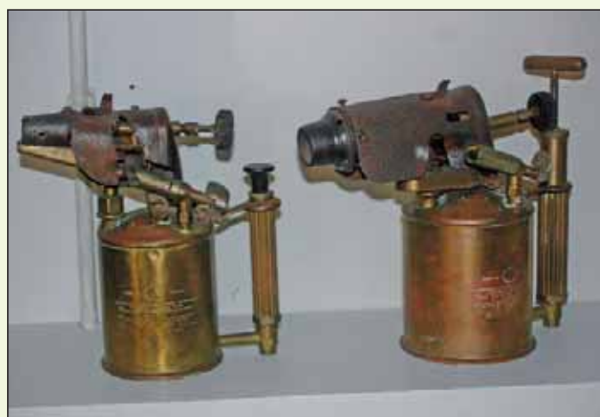
Blåselamper som ble benyttet til å varme opp blyet før man jobbet med kabelen, de ble også benyttet til lodding.
